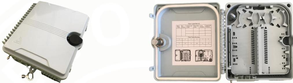
La caja exterior de distribución y empalme 12 F.O. TLX-76.14 se utiliza en el exterior de edificios para la red de FTTH, pudiendo utilizar también la tecnología PON (passive optical network) mediante splitter PLC o cassette. Permite su uso también en instalaciones con cable en paso.
