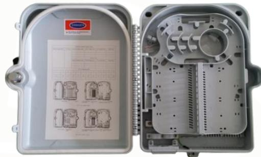
La caja exterior de distribución y empalme 24 F.O. TLX-76.09 se utiliza en el exterior de edificios para la red de FTTH, pudiendo utilizar también la tecnología PON (passive optical network) mediante splitter PLC o cassette. Permite su uso también en instalaciones con cable en paso.
