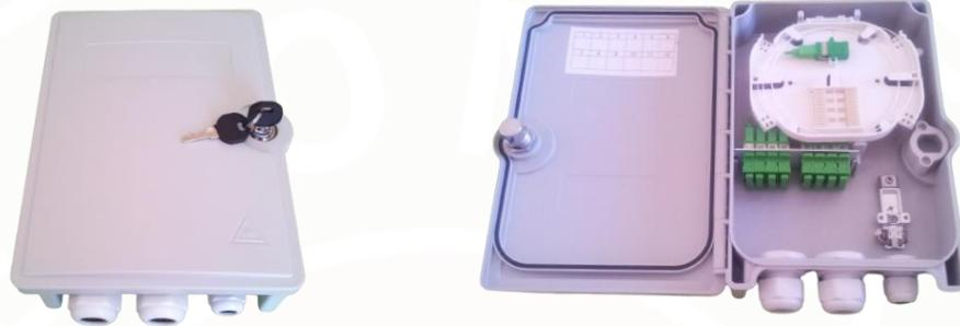
La caja de distribución y empalme para 16 fibras ópticas TLX-72.16 ofrece una solución flexible para aplicaciones tanto de interior como de exterior. Dispone de alojamientos para 8 adaptadores tipo SC duplex así como para un divisor tipo PLC 1x4/1x8 situado bajo la zona de giro de la bandeja porta empalmes. Esta bandeja es abatible a fin de permitir la organización y manejo de las fibras y tiene una capacidad máxima de 12 empalmes por fusión.
