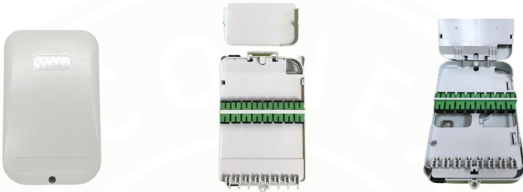
La caja de derivación en planta 16 abonados CDP16 TLX-72.13 se utiliza para conectar los cables de distribución vertical con los cables de acometida monofibra de los clientes en el interior de edificios. Se situará por tanto en cualquier planta de un edificio cuya instalación interior no disponga de espacio suficiente para permitir el tendido de la acometida hasta la caja terminal en las viviendas.
