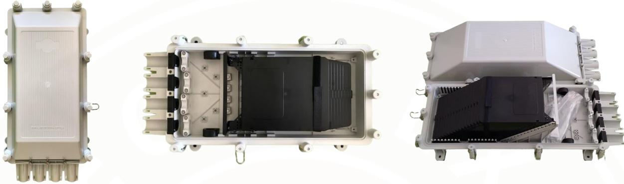
Las cajas de acceso universal F.O. SERIE 69 son utilizadas para albergar y proteger empalmes de fibra óptica. Su capacidad varía desde los 128 empalmes del modelo pequeño hasta los 512 del mayor. Se trata de una caja versátil, ya que puede ser utilizada en exterior o interior de edificios, en arquetas o en poste.
